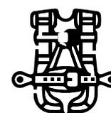
Anillo D esternal: ubicado en el centro del pecho del usuario, este anillo D está diseñado para crear un punto de sujeción a sistemas verticales utilizados para ascenso y descenso por escaleras.
