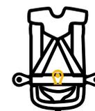
Anillo D posterior para la cintura: normalmente se encuentra en un cinturón en la base de la columna vertebral del usuario o junto a ella. Este anillo D está diseñado para usarse únicamente en aplicaciones de restricción.
